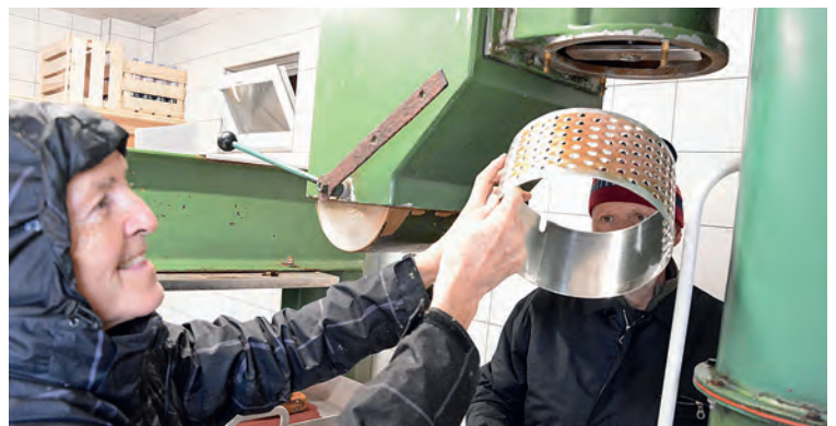
Mostereikunde Reinhard Stamm hilft beim Montieren der zylindrischen «Röstraffel». Sie wird oben in der Öffnung befestigt.
