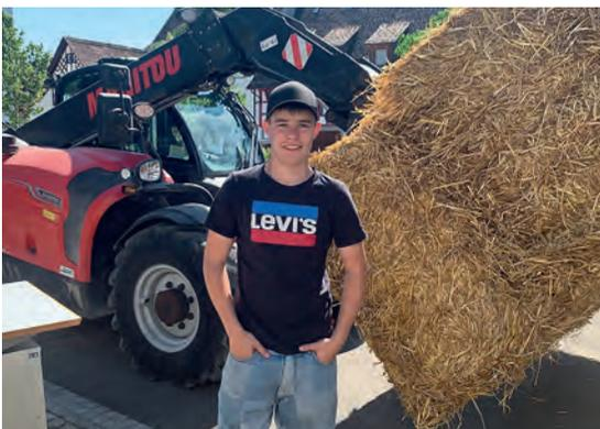
Nils Brütsch hat eine «Ballenzange» hergestellt. Sie wird auf den Arm des roten Teleskopladlers befestigt und dient dazu, Heu- und Strauballen zu ergreifen und zu den Kühen zu fahren. Bilder: vf
