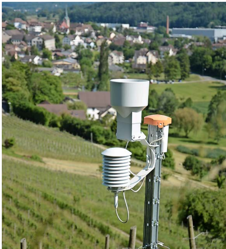
Diese Wetterstation steht im Rebberg Stoffler in Thayngen. Sie misst die Temperatur, die Niederschlagsmenge und die Blattfeuchtigkeit. Rebbauer Thomas Stamm kann die Daten mit seinem Smartphone abrufen. Bild: vf
