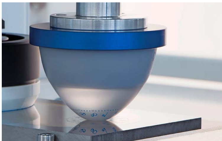
Ein Drucktampon aus Silikon nimmt Farbe auf und überträgt sie auf das zu bedruckende Teil.
