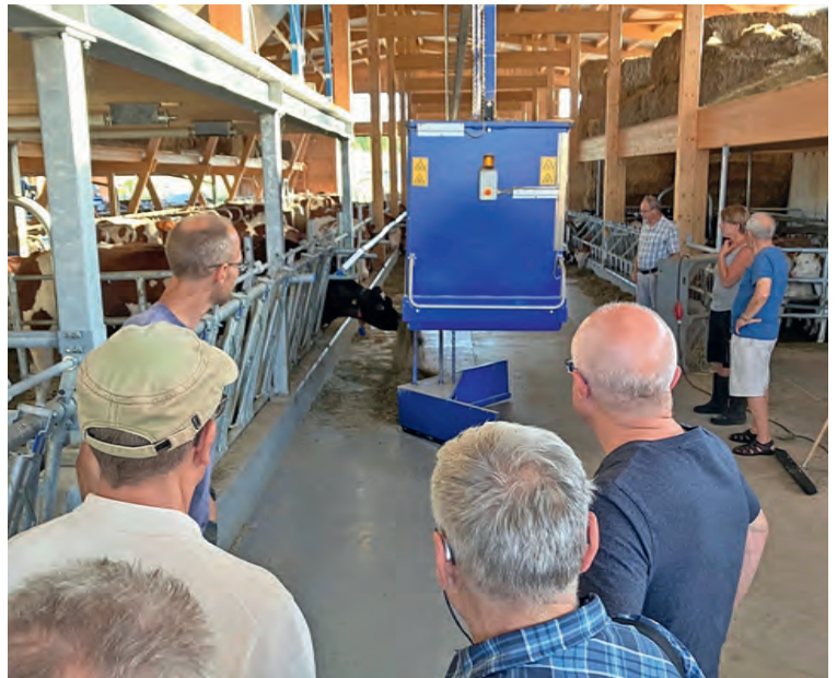
Das auf Schienen geführte und elektrisch getriebene Futterdosiergerät bringt den Kühen ganztags frisches Futter zur Krippe.
