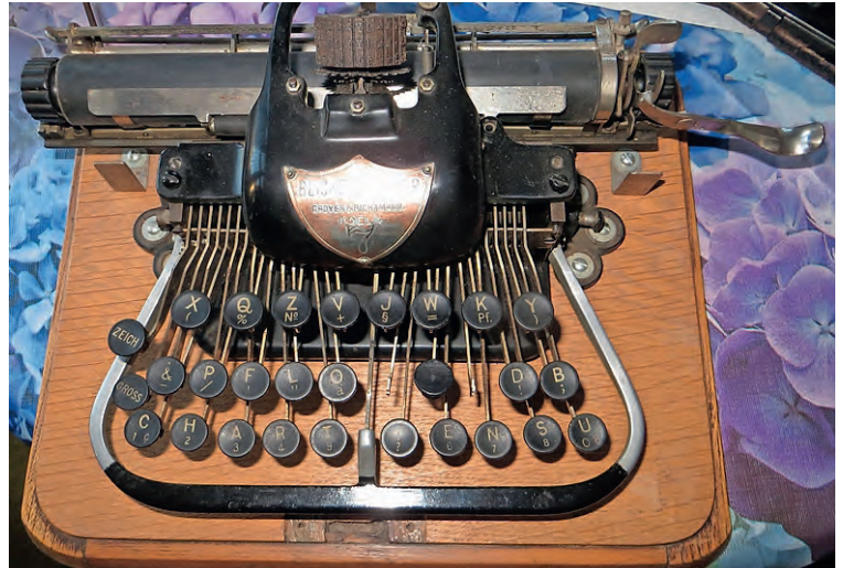
Die zurückgelassene Blickensderfer ist schmutzig und rostig. Zudem fehlen zwei Schreibtasen. Bild: zvg
