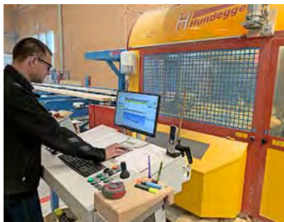
Planer Philipp Bernhard vor der Abbundanlage, die Holzteile automatisch bearbeitet.
